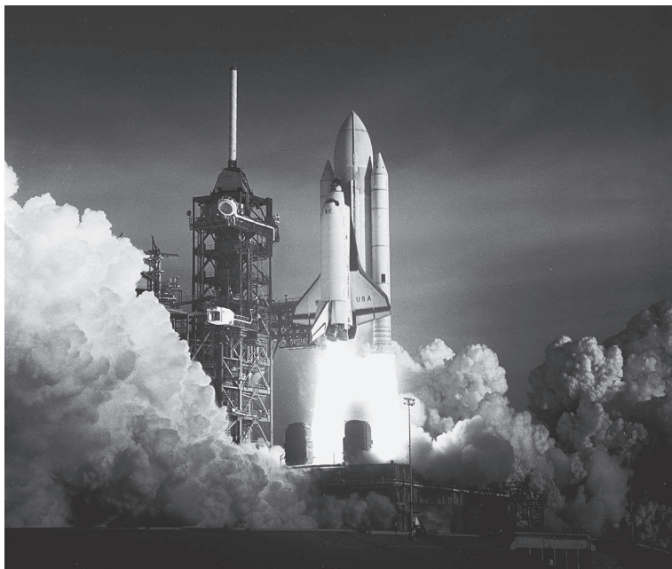
Foguetão movido a vapor: o veículo espacial reutilizável da NASA usava a reação entre o oxigénio e o hidrogénio para criar água e propulsionar-se para o espaço.
